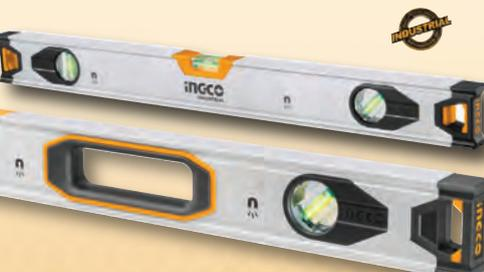
Doppio lato zigrinato; 3 bolle di precisione 0,5mm/m; Spessore alluminio: 1,5mm; scanalatura a V per misurazione oggetti a forma tonda. Disponibile nelle misure da: 300, 400, 600, 800 e 1.000 mm.
