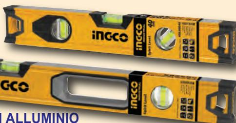
Doppio lato zigrinato; 3 bolle di precisione 0,5mm/m; Spessore alluminio: 1,5mm; scanalatura a V per misurazione oggetti a forma tonda. Disponibile nelle misure da: 300, 400, 500, 600, 800 e 1.000 mm.
